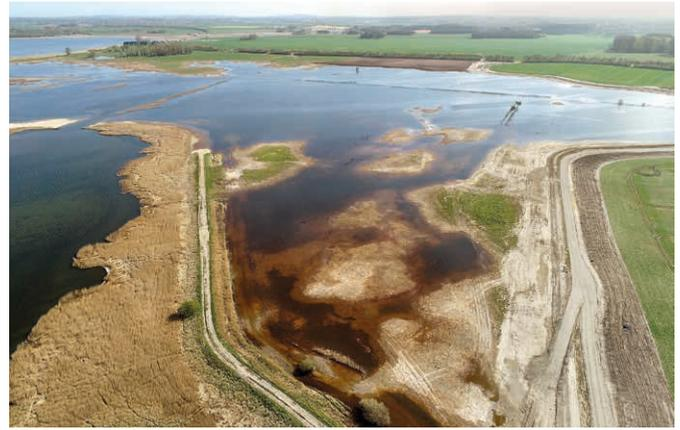
**Abb. 4:** Luftaufnahme des Polders Drammendorf am 17.4.2020 nach der Renaturierung. Der alte Deich ist bis auf einen kurzen Rest verschwunden, der neue Riegeldeich (rechts im Bild) schützt die Ackerflächen östlich des Deichs. (Foto: © WWF)
